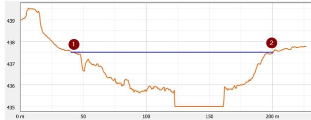
Querprofil durch den Muttliweiher gemäss den LiDAR Daten von Swisstopop (ohne bathymetrische Daten)
